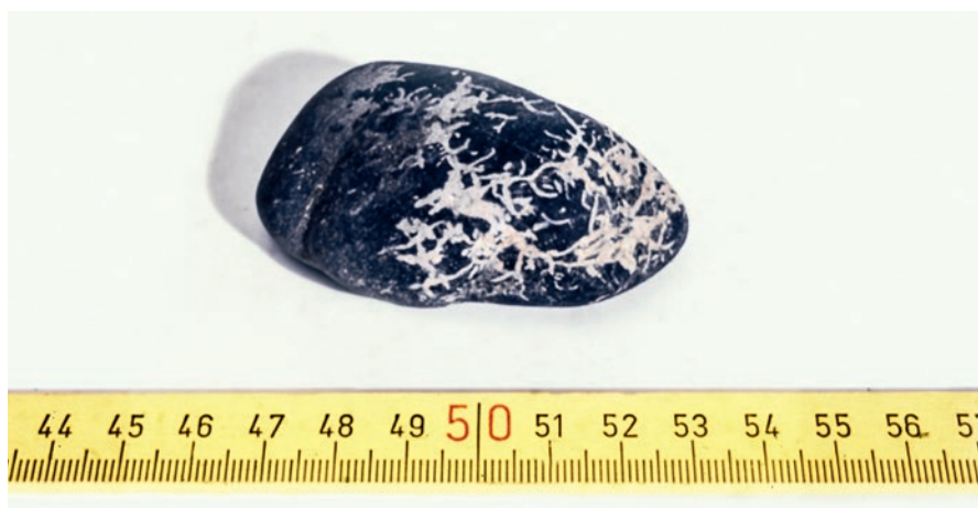
Einzelgeröll aus tiefenverwittertem Schotter mit Lösungsspuren durch Wurzelwachstum
