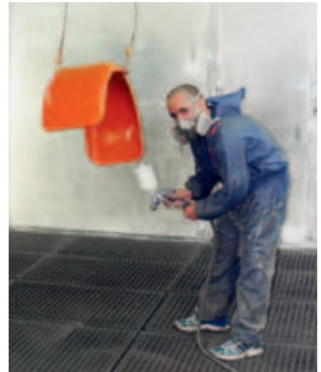
Die Abluft aus Spritzkabinen muss über eine Filteranlage gereinigt werden.
