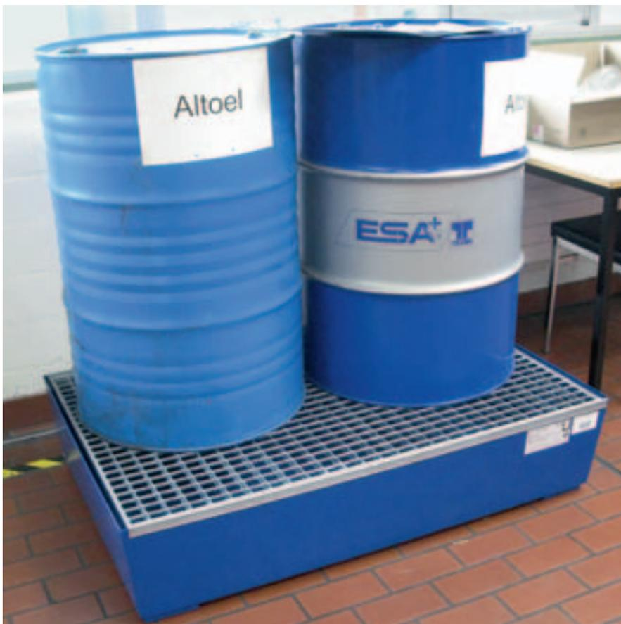
Auslaufende Flüssigkeiten müssen zurückgehalten werden: Auffangwannen beim Gebindelager.
