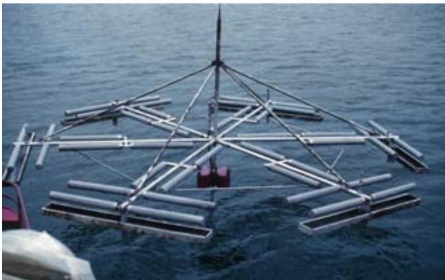
*Jeder der sechs Diffusoren besitzt an den sechs Armen je sieben Filterker- zen, durch die feine Sauerstoffblasen erzeugt werden. Stabilisatoren ermöglichen ein sanftes Absetzen auf dem schlammigen Seegrund. An den Armen befinden sich aussen Düsen zur Erzeugung grober Blasen im Winter.*
