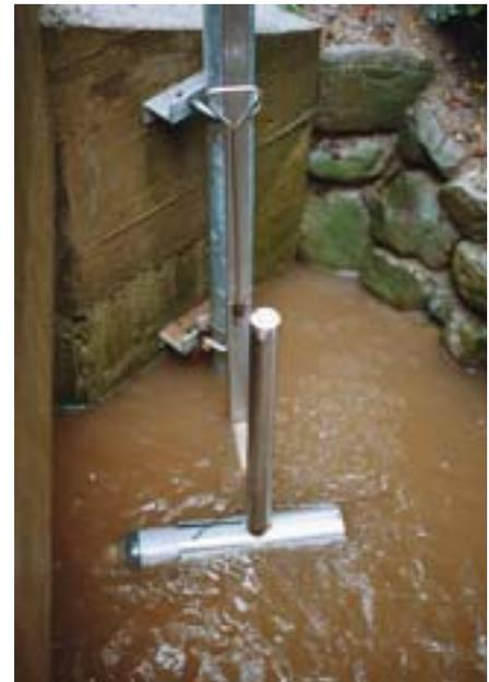
Bei Hochwasser steigt der Wasserstand und der Probensammler füllt sich. Durch Regulierung der ausströmenden Luft kann die Füllrate vorgegeben werden.
