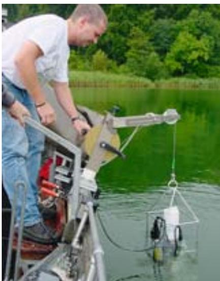
*Daniel McGinnis beim Absenken einer Multisonde zum Erfassen von Temperatur-, Leitfähigkeits- und Sauerstoffprofilen im See und zur Vermessung des Blasenschleiers.*
