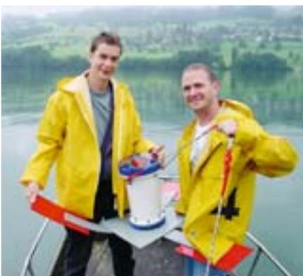
Andreas Lorke (links) und Daniel McGinnis (rechts) vor dem Einsatz eines auf Ultraschall basierenden Strömungsmessgeräts für Profile im See (gleiches Prinzip wie die Radarfalldaten der Polizei). Mit diesem Instrument können gleichzeitig auch die Insektenlarven Chaoborus beobachtet werden.
