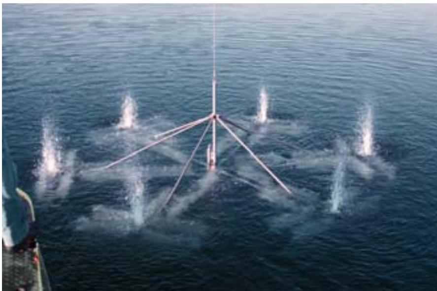
*Funktionstest eines Diffusors an der Wasseroberfläche nach der jährlichen Reinigung. Die Wasserfontänen werden durch die groben Blasen der Düsen erzeugt. Das getrübtete Wasser entsteht durch die feinen Blasen an den Filterkerzen.*
