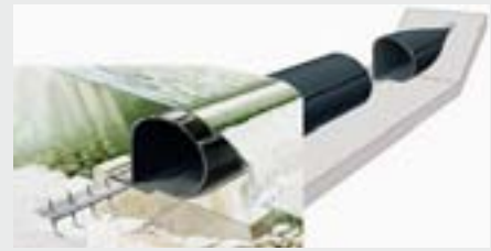
Konstruktion eines Schlauchwehrrs
