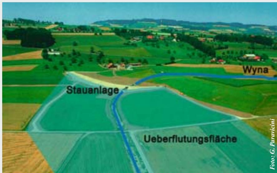
Hochwasserrückhaltebecken Eichmatt, Beromünster an der Wyna. Dieses Rückhaltebecken dient dem Schutz von Beromünster, Menziken und Reinach.
