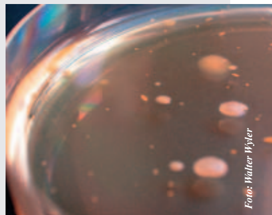
Ermittlung der Keimzahl mittels mikrobiologischer Untersuchungsmethode
