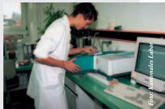
Mithilfe des Fotometers wird der Eisengehalt des beprobten Wassers bestimmt.
