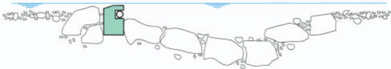
Ein Kolkbecken dient der optimalen Durchmischung des Kühlwassers mit dem Wiggerwasser und hält die Austrittsöffnung des Einleitungsrohrs frei.
