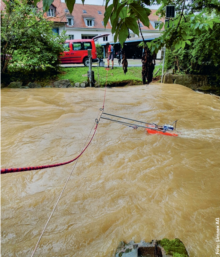
Eichmessung an der Messstation am Bruggbach in Gipf-Oberfrick am 15. Juli 2021: Sensoren im Messboot messen Fließgeschwindigkeit und Wasserstand – so kann die Abflussmenge berechnet werden.
