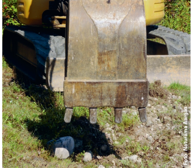
Kleinbagger mit einem mit Zähnen bestückten Grablöffel eignen sich ideal für die Auffrischung von grösseren Ruderalflächen.
