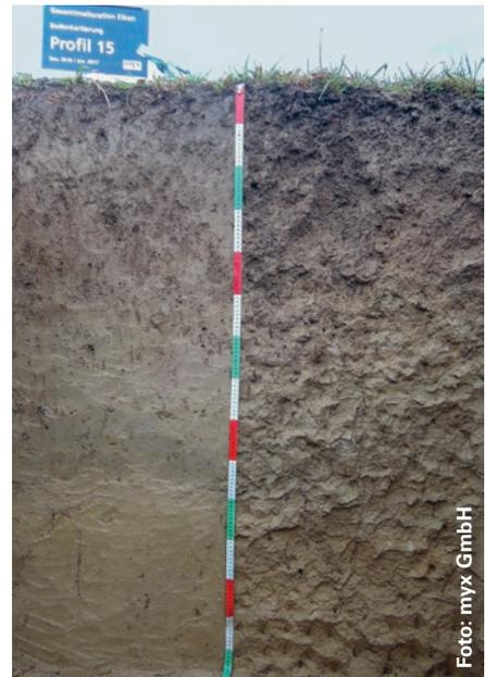
*Dieses Profil (Gesamtmelioration Eiken) zeigt einen flachgründigen Regosol (Rohboden) in einer Kuppenlage. Im Gegensatz zur Parabraunerde ist hier die Bodenbildung erst wenig fortgeschritten. In zirka 40 Zentimetern Tiefe zeigt sich der Übergang vom Boden zum unverwitterten ockerfarbenen Löss.*
