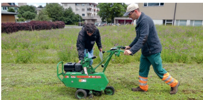
Der Sodenschneider zieht ein Messer durch den Boden und schneidet so die bestehende Vegetation auf (links). Der Rasen kann dann aufgerollt und einfach entfernt werden (rechts). So ist der Boden für eine sofortige Aussaat bereit.
