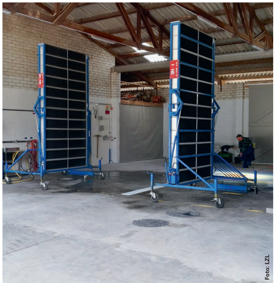
Der Waschplatz auf dem Brynerhof in Othmarsingen hat einen Lamellenprüfstand.
