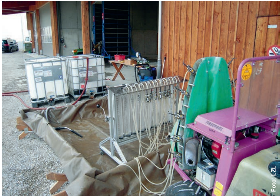
Im Ausliterungsstand wird der Durchfluss jeder einzelnen Düse geprüft. In Hintergrund sind die Entsorgungstanks sichtbar.
