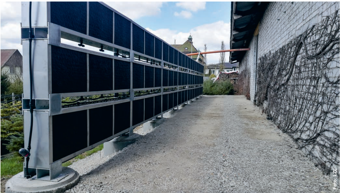
Verdunstungsanlage zum Abbau von Pflanzenschutzmittel-Wirkstoffen via Mikroorganismen und Photolyse
