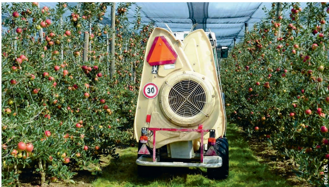
Damit die Applikation von Pflanzenschutzmitteln zielgerichtet erfolgt, werden Pflanzenschutzspritzen (hier eine Gebläsespritze) regelmässig von anerkannten Prüfstellen kontrolliert und neu eingestellt.
