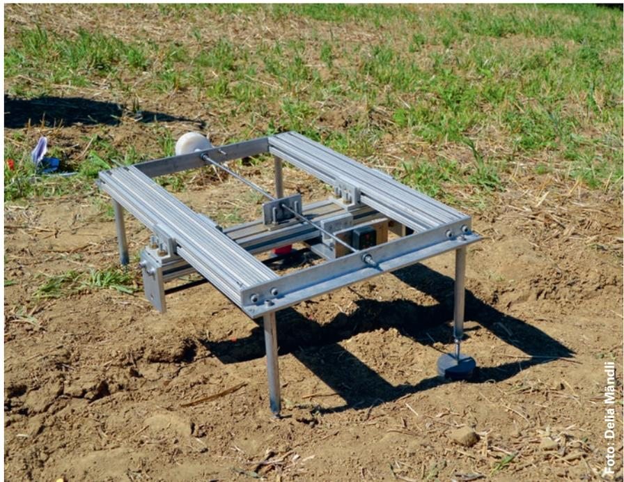
Lasermessung als Validierungsmethode. Fazit ist, dass mit Drohnen das Abtragsvolumen mit ähnlicher Genauigkeit erfasst werden kann wie mit der bisherigen Schadenskartierung.
