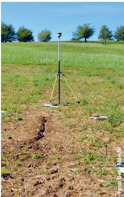
Volumenabschätzung von Bodenabtrag mithilfe einer Drohne und der im Bild sichtbaren GPS-Station zur genauen Positionierungsbestimmung.
