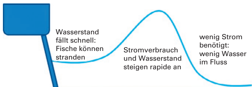
Illustration der Wasserstände unterhalb eines Kraftwerks mit Schwall-Sunk-Betrieb
