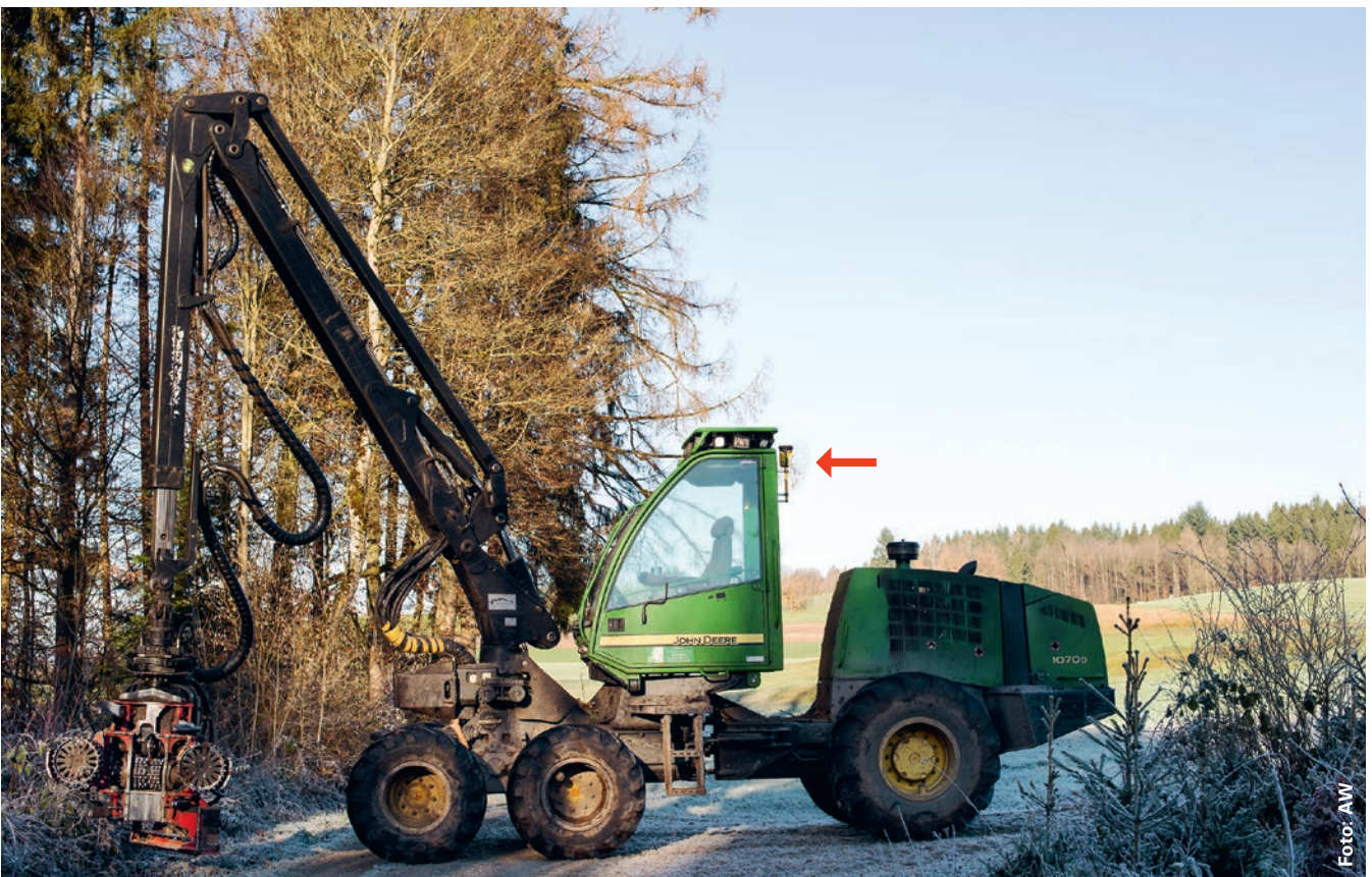
Das GPS wurde hinter der Kabine des Vollernters der Firma Wiss AG angebracht.
