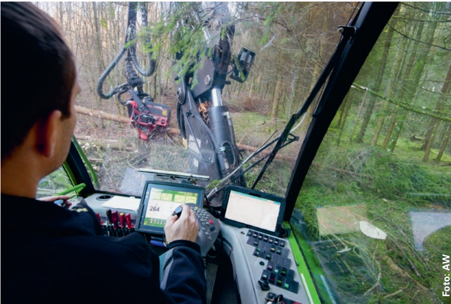
Sicht aus der Vollernterkabine: Auf dem Tablet rechts sieht der Maschinist die Rückegassen und seine Position.
