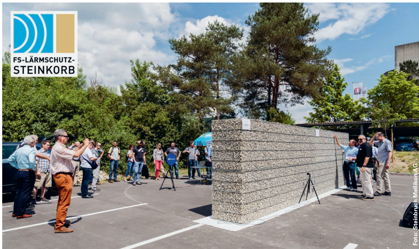
Lärmmessungen vor Ort beweisen es: Die Steinkörbe mit dem integrierten Dämmelement aus Gummierecyclingmaterial reduzieren den Lärm nicht nur, sondern absorbieren ihn auch.
