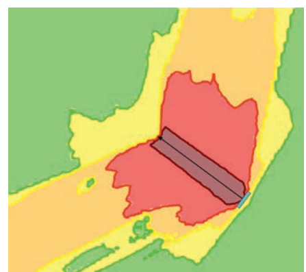
Lärmsimulation mit sonARMS: Die Abbildung links zeigt den Ausgangszustand der Anlage, ohne bauliche Massnahmen. Rechts wird die Lärmsituation der gleichen Anlage nach Aufrüstung mit Schallschutztunnels dargestellt. Deutlich erkennbar ist die Pegelminderung des Mündungsknalls mit einer markanten Reduktion der hochbelasteten roten Flächen im Bereich des Schützenhauses (blau). Schallschutztunnels haben keine lärmmindernende Wirkung auf den Geschossknall: Die beiden roten Kurven beider Simulationen sind ab einem gewissen Abstand zum Schützenhaus praktisch identisch. Quelle: AfU
