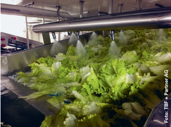
Zwei Beispiele, in denen unterschiedlich stark verschmutztes Abwasser entsteht: Beim Waschen von Salat entsteht nur leicht verschmutztes Abwasser (links). Bei der Verarbeitung von Rindfleisch ist das Abwasser stark mit erdhaltigen Verschmutzungen belastet (rechts).
