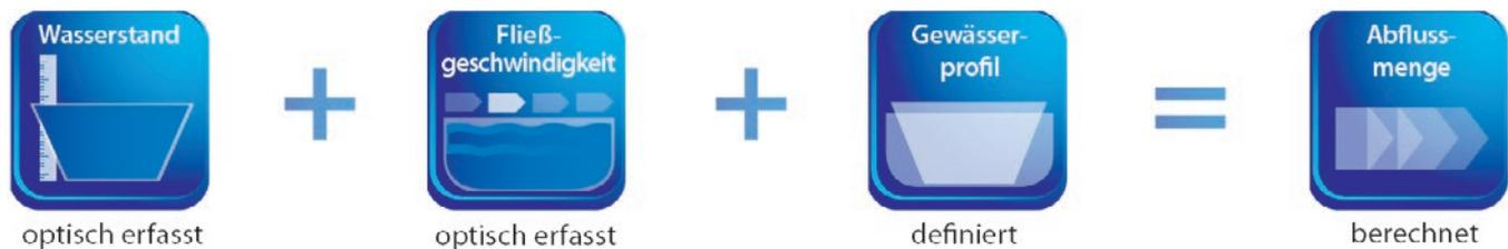
Innerhalb von zirka 40 Sekunden sind die Messergebnisse der mittleren Fließgeschwindigkeit, des Wasserstandes und des Abflusses verfügbar. Neben den digitalisierten Messwerten werden auch aktuelle Bilder gespeichert und an einen kantonalen FTP-Server übertragen.
