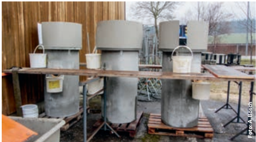
Versuchsanlage auf dem Werkhofareal in Oftringen: Hier wurden Ausstiegshilfen aus verschiedenen Materialien getestet.
