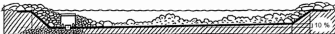
Ablasssystem A: Einfaches Ablasssystem mit Pfropfen (Gummizapfen) verschlossen und Betonschacht mit Deckel
