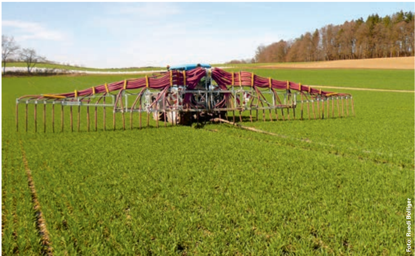
Schleppschlauchverteiler ermöglichen einen pflanzen- und bodenschonenden sowie emissionsarmen Austrag von Gülle und flüssigem Gärgut.
