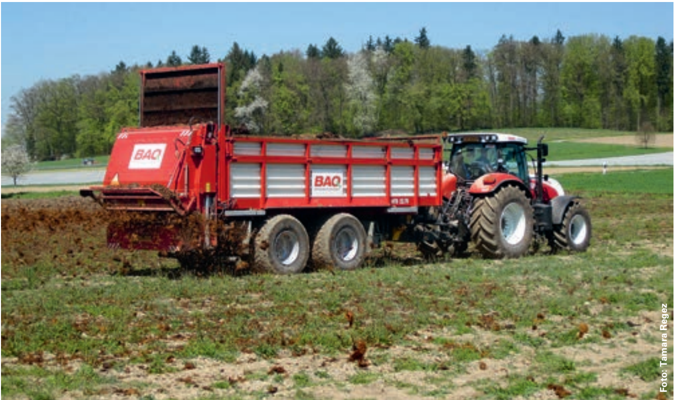
Spezialstreuer ermöglichen eine gleichmässige Verteilung von Kompost und festem Gärgut.
