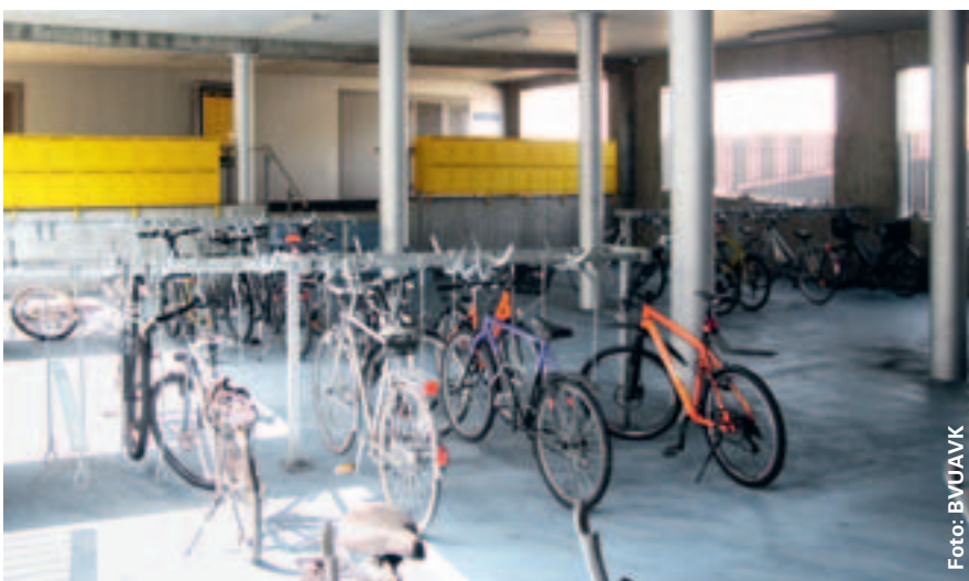
Gedeckte Anlage mit Lenkhalter inkl. Zusatzkabel. Im Hintergrund sind kleine Schliessfächer für die Aufbewahrung des Helms sichtbar.
