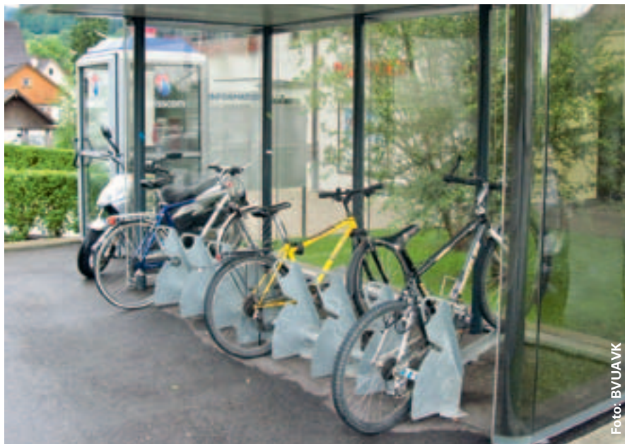
Gedeckte Veloanlage mit Diebstahlschutz: Am Pedalhalter können Hinterrad und Rahmen angeschlossen werden.
