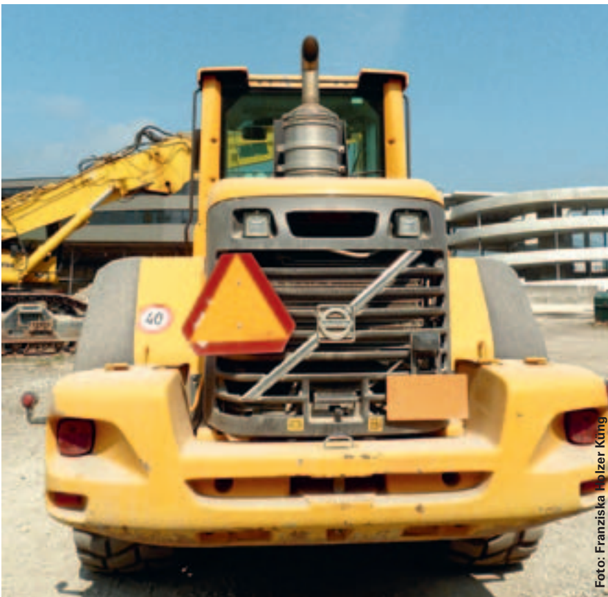
Pneulader mit markantem, nachträglich aufgebautem Partikelfilter.
