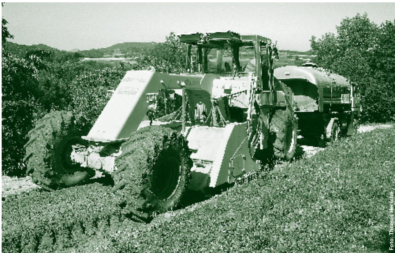
Bei diesem Weg wird der Wegkoffer durch eine Zementstabilisierung verstärkt.
