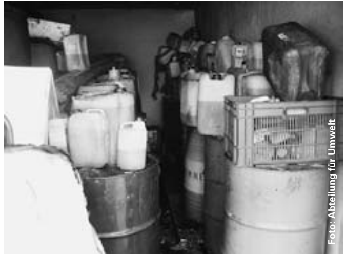
Unzulässige Lagerung von wassergefährdenden Flüssigkeiten
