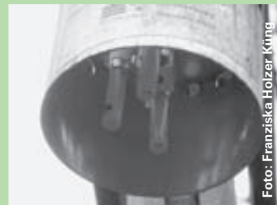
Passivsammler bestückt mit drei Diffusionsröhren.
