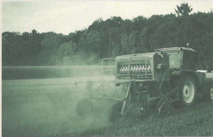
Direktsaat-Technik: Säen von Ackerkulturen ohne vorherige Bodenbearbeitung und ohne Stickstoff-Mineralisationsschub in ein Stoppelfeld.
