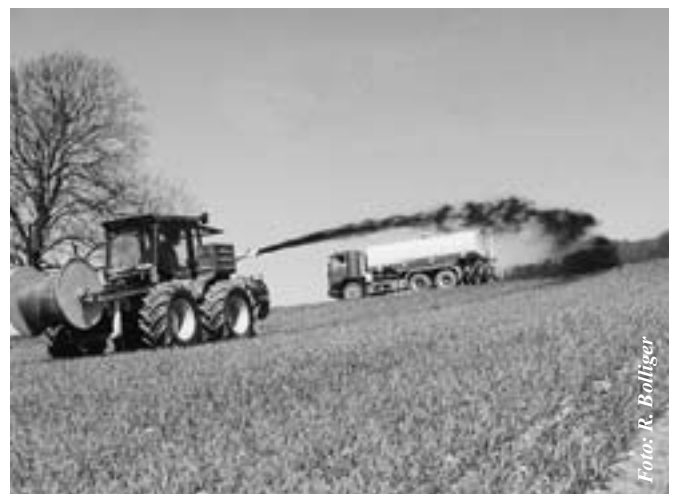
Die Verschlauchung mit mobilem Verteilfahrzeug wurde zunehmend durch Schleppschlauchverteiler abgelöst.
