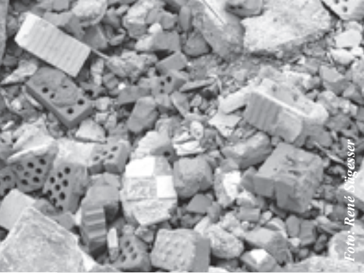
Typischer Mischabbruch mit Kalksandsteinen, Ziegeln, Backsteinen und Beton
