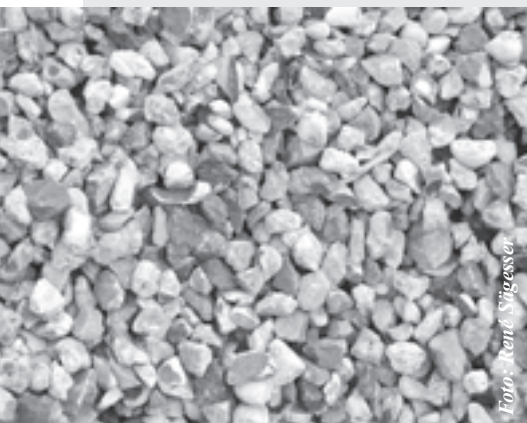
Recyclingkiessand B: Kiessand mit max. 20 Prozent Betongranulat
