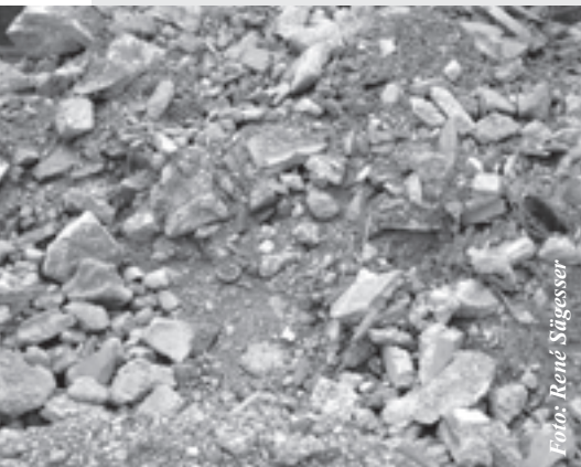
Mischabbruch mit hohem Feinanteil. Dieser muss vor dem Brechen abgeseibt werden.
