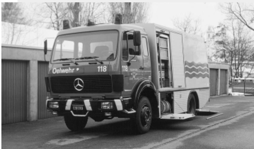
Zehn der zwölf Stützpunkte verfügen über dieses Ölwehrfahrzeug, Typ AG 86.
