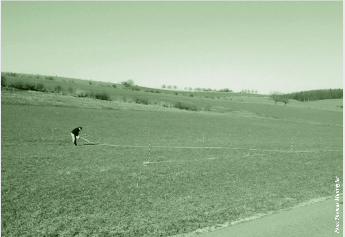
Einmessen eines Standortes für eine Vierfachbeprobung
