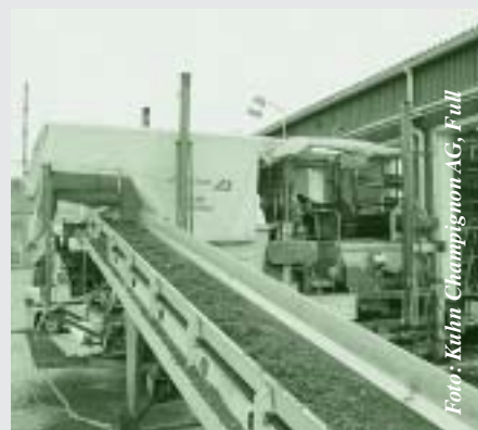
Die Abfüllmaschine bringt den mit Champignon-Myzel durchwachsenen Kompost auf Beete aus.
