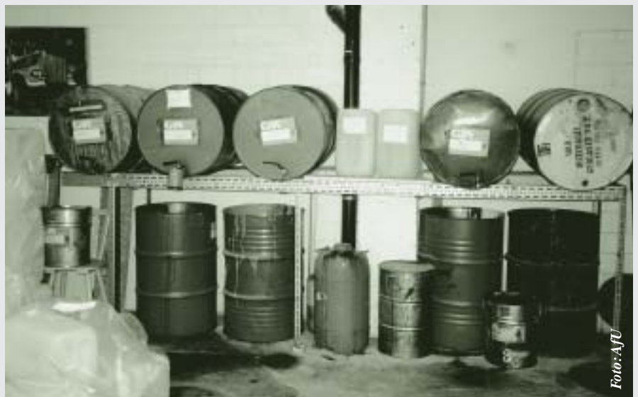
Ohne die heute üblichen Wannen und Schutzschichten konnten Lösungsmittel früher durch Betonplatten hindurch in den Untergrund eindringen.
