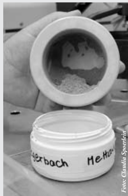
Die getrockneten Sedimentproben werden im Labor aufbereitet.
