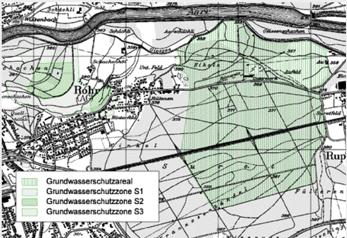
Grundwasserfassung «Rohr III» mit umgebenden Grundwasserschutzonen (links) und Grundwasserschutzareal «Suret» (rechts).
