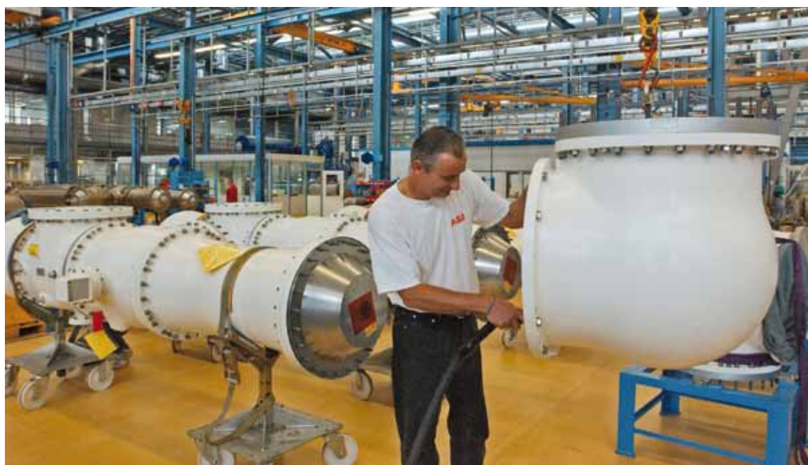
Ein Mitarbeiter bei der Montage an einer hochmodernen, gasisolierten Schaltanlage, welche die ABB in Zürich-Oerlikon produziert.
