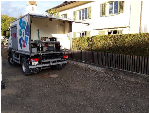
Abb. 1: Plattendruckversuche Zwischenplanie Strasse
