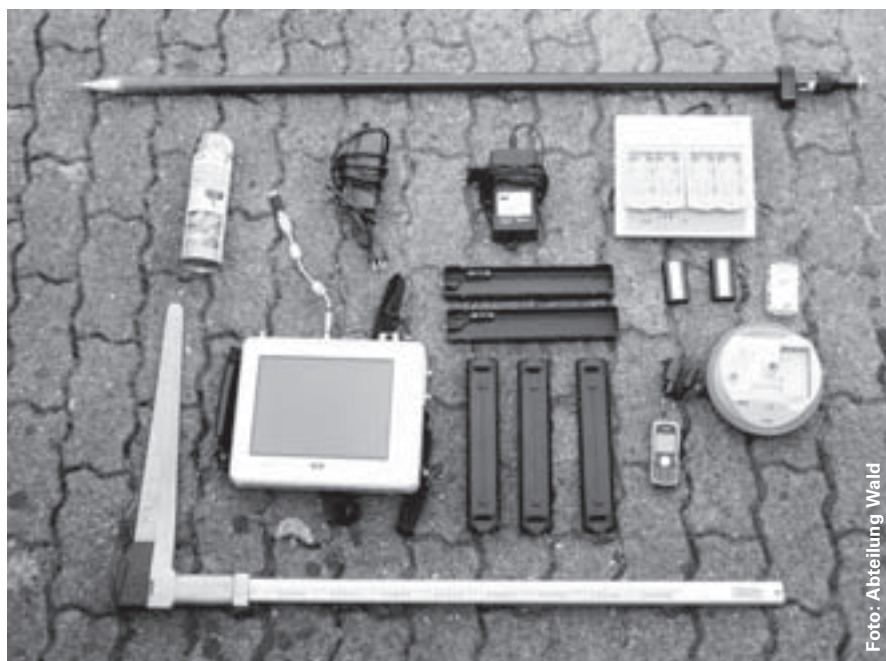
Ausrüstung für die Eichenkartierung: Kluppe, Markierspray, Feldcomputer, Mobiltelefon, Empfänger für Satellitensignal mit Stativ, diverse Ladegeräte und Ersatzakkus
