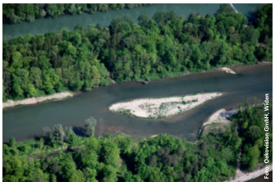
Das Flussbett der Alten Aare wurde mit Kiesinseln, Uferschüttungen und künstlichen Anrissstellen strukturiert. Weiter dienen Bühnen der Strömunglenkung, wodurch ein abwechslungsreicher Flusslauf entsteht.
