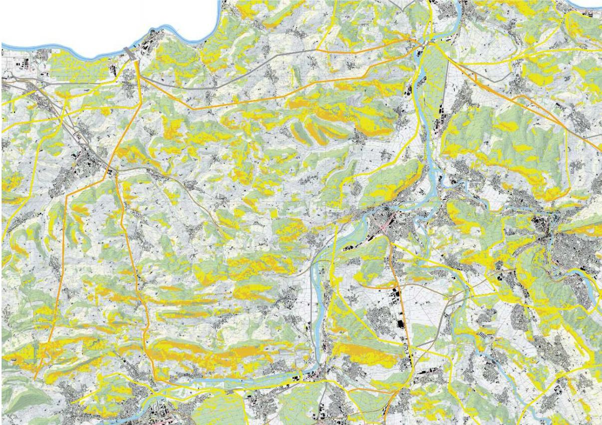
**ABB. 24: IN GELB (LEICHT ERHÖHT) UND ORANGE (ERHÖHT) SIND STARKSTROMLEITUNGEN, DIE DURCH WALDGEBIETE MIT EINEM LEICHT ERHÖHTEN BIS ERHÖHTEN ENTZÜNDUNGSPOTENTIAL FÜHREN (AUSSCHNITT ZEIGT DEN NÖRDLICHEN KANTONSTEIL). IN GRAU SIND ALLE ÜBRIGEN STARKSTROMLEITUNGEN.**
