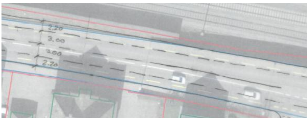
Abbildung 26: Ideenskizze zur Umsetzung der Velovorzugsroute – Abschnitt Kappelerhof Ost
