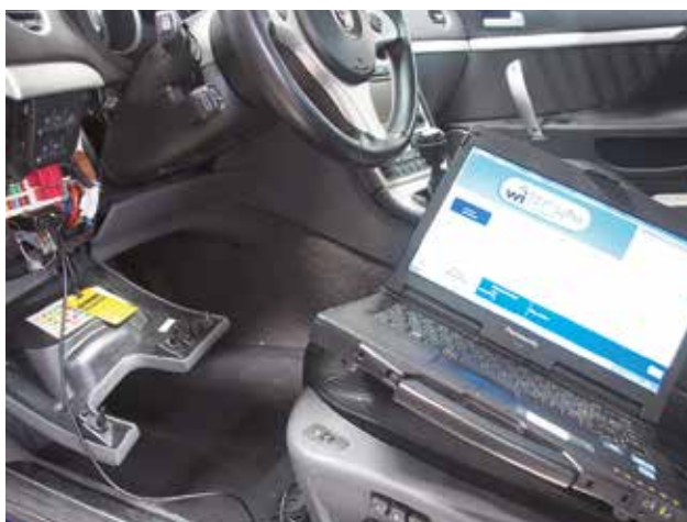
Das Diagnosegerät wird an die Elektronik des Autos angeschlossen.
