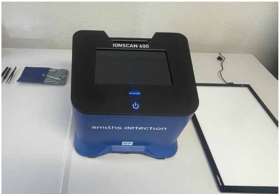
Mit Hightech gegen Drogenschmuggel: Kleinste Spuren von Drogen können mit IONSCAN 600 nachgewiesen werden.
