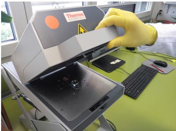
Abb. 1: Ein Fingerring wird zur Bestimmung der Metallgehalte im Röntgenfluoreszenz Handgerät (XRF) platziert.
