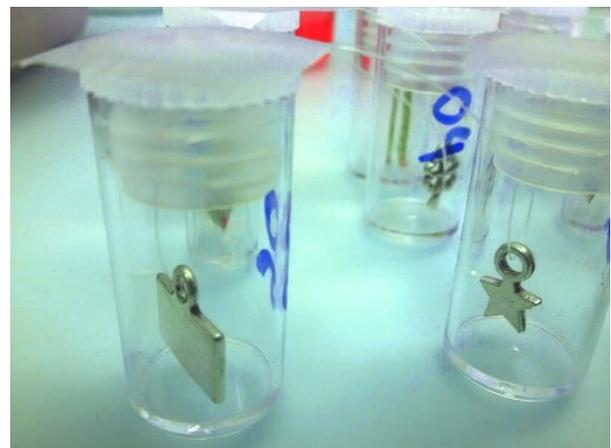
Abb. 6: Die Proben werden in Schweisslösung aufgehängt.
