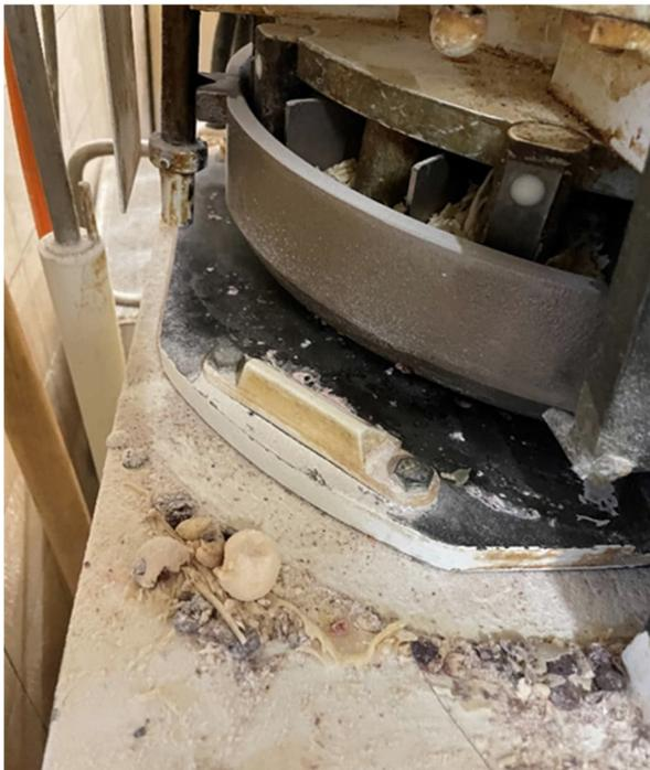
Abb. 18: Verschmutzte Aufwirmaschine
