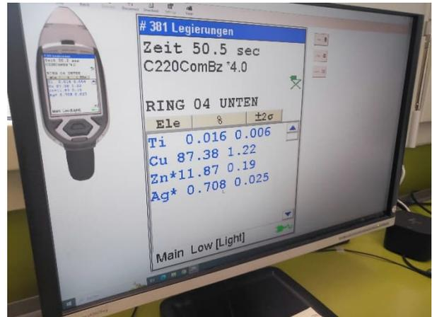
Abb. 2: Die Zusammensetzung der Legierung kann in kurzer Zeit bestimmt werden.
