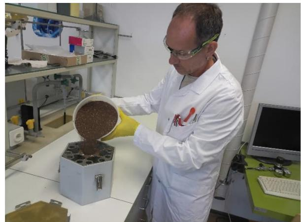
Abb. 5: Reto Stadler füllt das Rotationsgefäss mit einem Granulat, das den mechanischen Abrieb simulieren soll.
