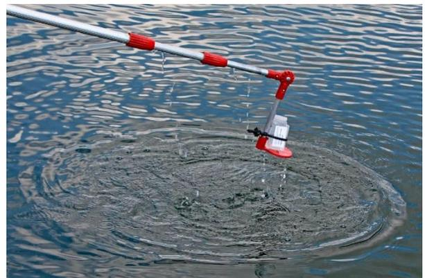
Abb. 23: Die Probenahme zur Untersuchung der Badewasserqualität an Fluss- und Seebädern erfolgt standardisiert gemäss den Empfehlungen des BAFU.
