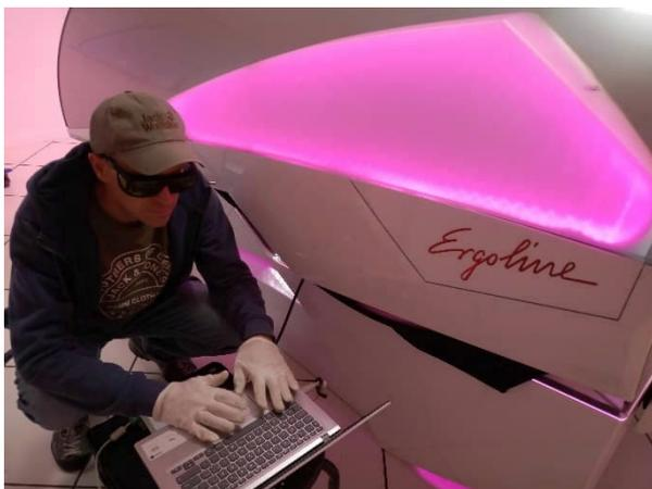
Abb. 3: Kontrolle der Messung live am Notebook. Während der Strahlungszeit trägt der Kontrolleur entsprechende Schutzkleidung wie Brille und Handschuhe.
