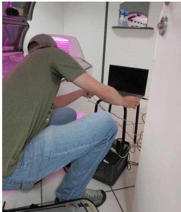
Abb. 1: Die mobile Messtechnik wird vor Ort aufgebaut, um die Strahlung in der Solarium-Liege zu messen.
