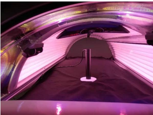
Abb. 11: Mit diesem Messgerät wurde die Strahlungsintensität von Solarien gemessen.
