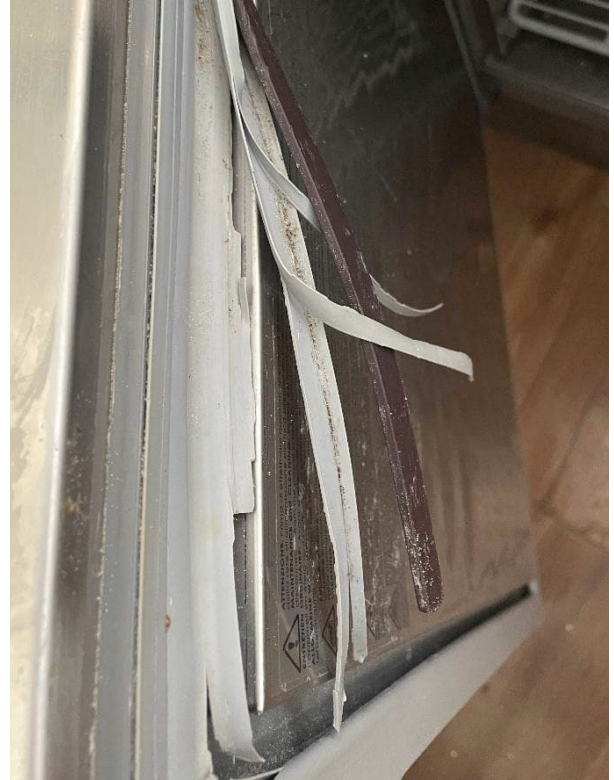
Abb. 4: Defekte, nicht reinigbare Dichtung
