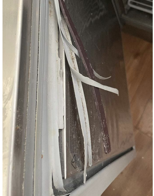
Abb. 4: Defekte, nicht reinigbare Dichtung
