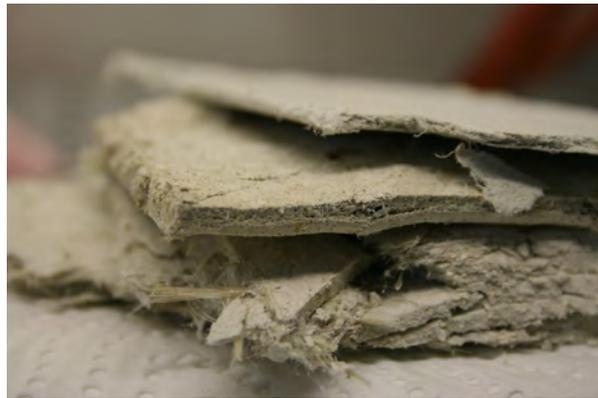
Abb. 9: Asbesthaltige Leichtbauplatten
