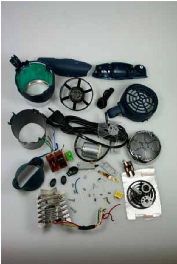
Abb. 8: Haartrockner, der für die Überprüfung der RoHS-Konformität in seine Einzelteile zerlegt wurde.
